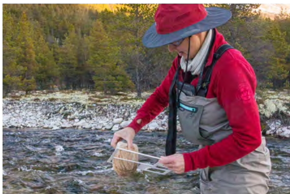
Figur 7.6: Måling av sediment er en viktig metode for å bestemme limnisk substrattype. Atna elv i Stor-Elvdal kommune. Foto: Børre Dervo, 2019.
