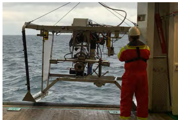
Figur 7.7: Videoriggen «Chimaera» på MAREANO tokt med FF «G.O. Sars» som jobber 24 timer i døgnet til havs. Foto: NGU.
